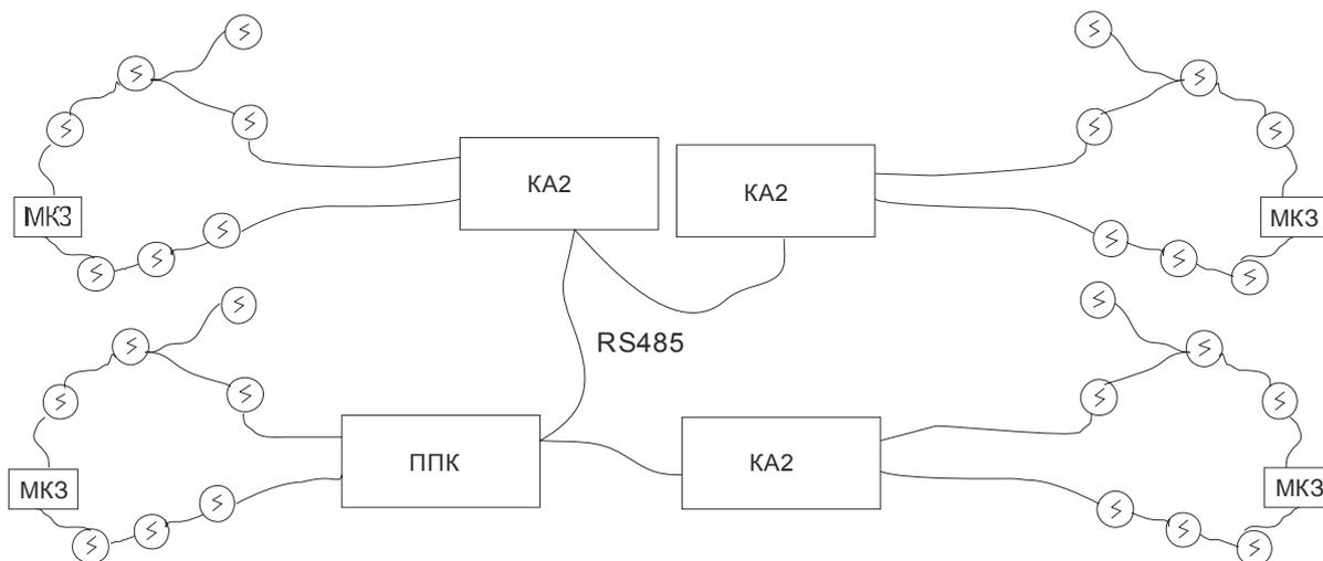
**Рис. 11 Увеличение адресных устройств при помощи КА2**
