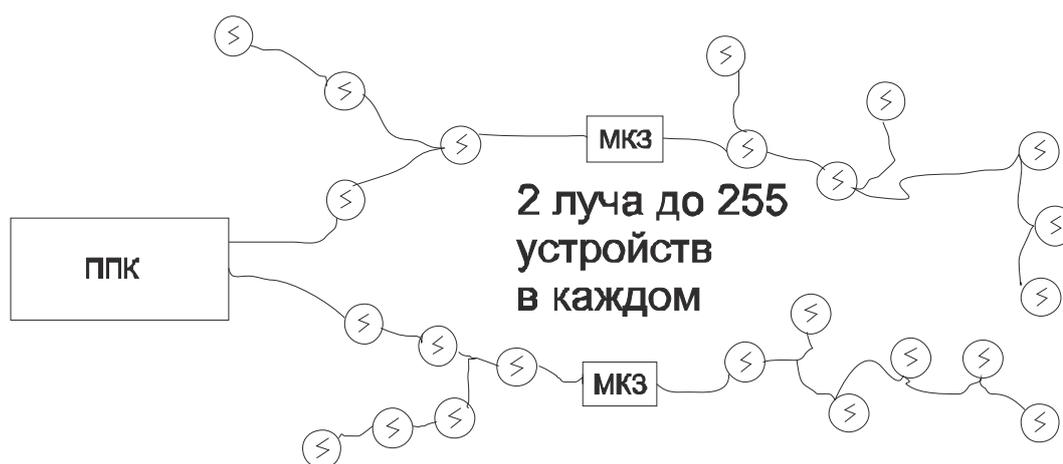
**Рис. 10 Подключение адресного шлейфа в режиме «два луча».**
