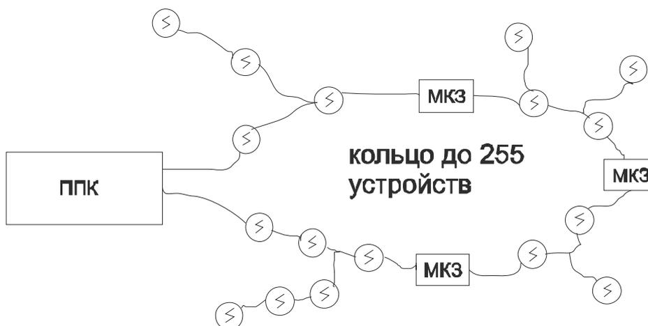
**Рис. 9 Подключение адресного шлейфа в режиме «кольцо».**
