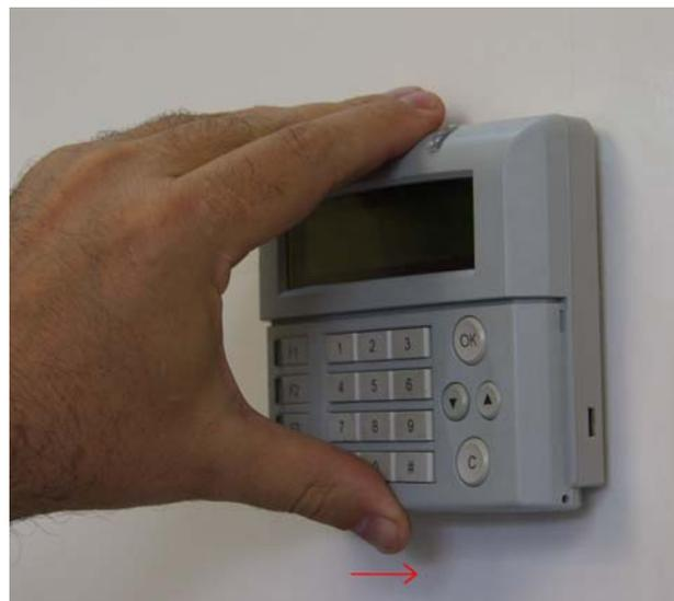
**Рис. 5 Снятие и установка крышки ППК**
