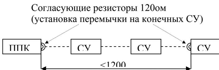
**Рис. 8 Подключение сетевых устройств на линию RS-485.**
