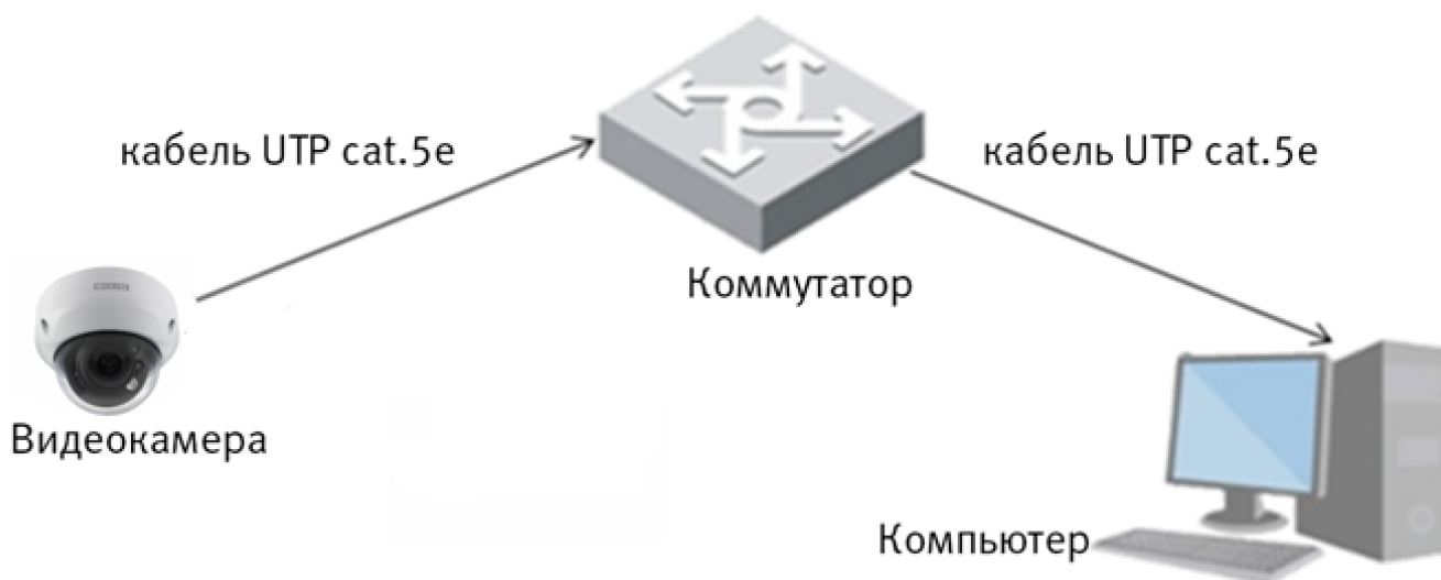
Рисунок 6.3 - Схема подключения видеокамеры к компьютеру через коммутатор
