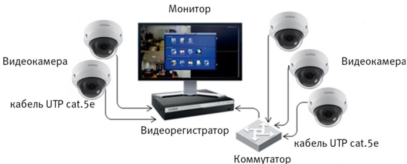
Рисунок 6.4 – Схема подключения видеокамеры к видеорегистратору
