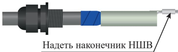
Надеть корпус устройства оконечного на экран
