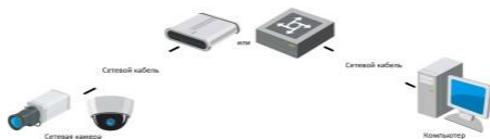
Рисунок 4-2 Подключение через коммутатор или роутер
