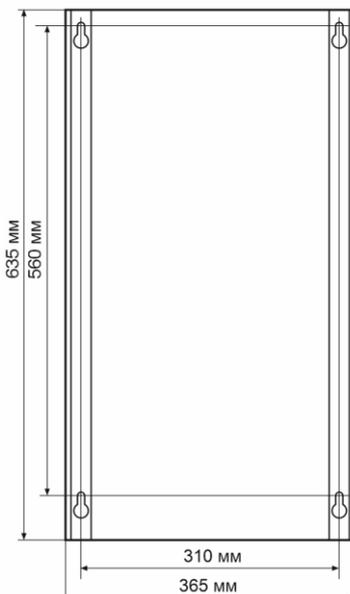
Рисунок 3. Размеры и крепление стабилизатора на стену
