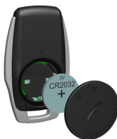
Figure 1 Remplacement de la batterie
