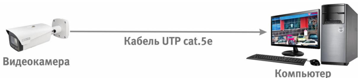
Рисунок 6.3 – Схема подключения видеокамеры к компьютеру
