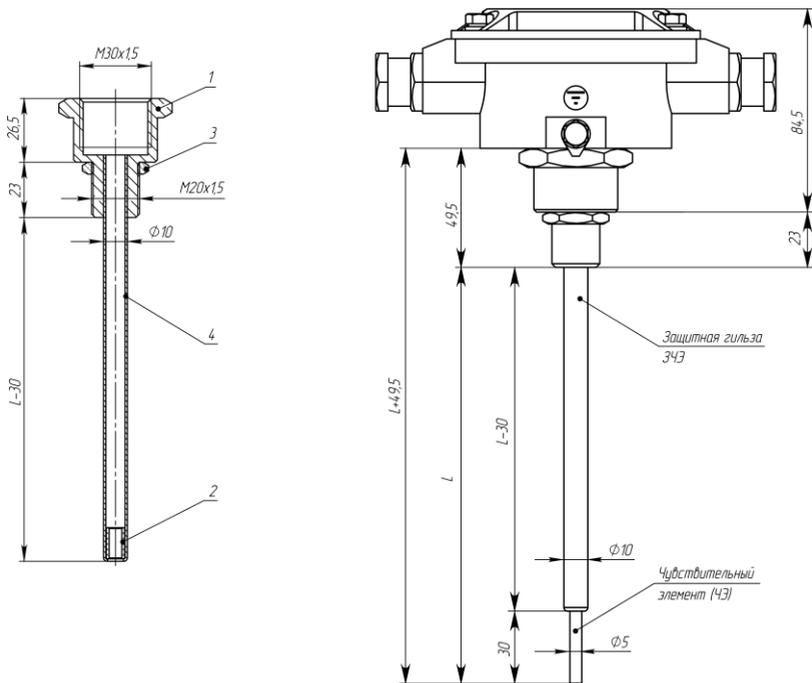
На рисунке показано: 1 - переход; 2 - втулка; 3 - гайка M20x1,5; 4 - трубка; L - заказная длина чувствительного элемента извещателя (по умолчанию L=200 мм).
