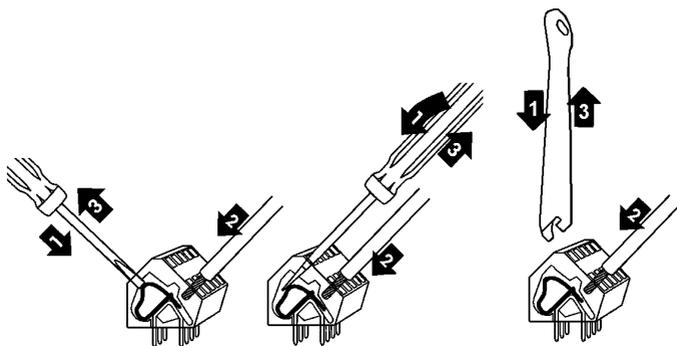
Для подключения проводников в клеммы:
